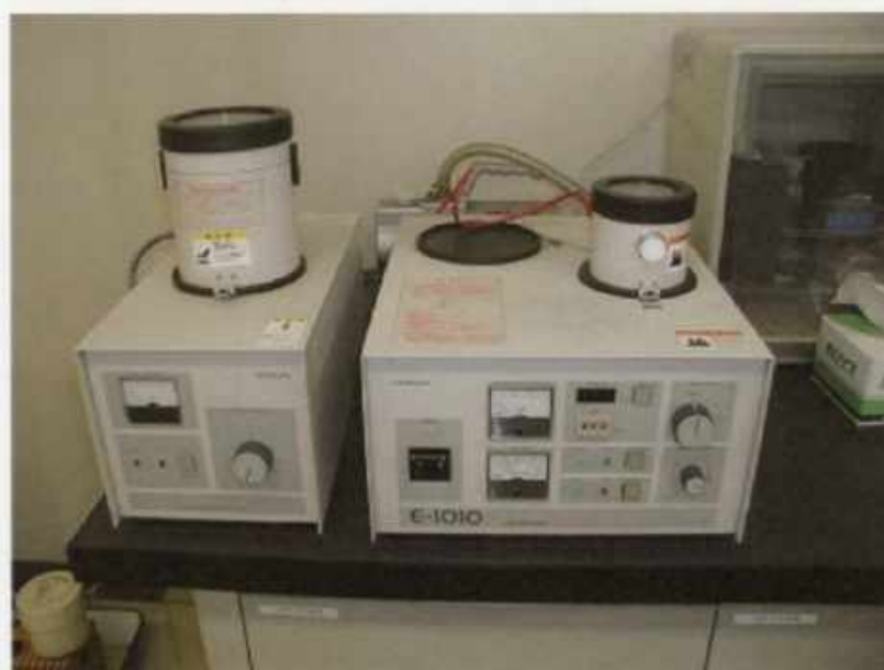
写真-12 白金- パラジウムコーティング 状況
